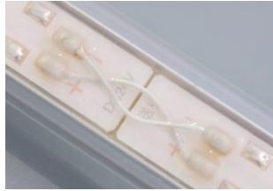
LED基板全面防水コーティング
