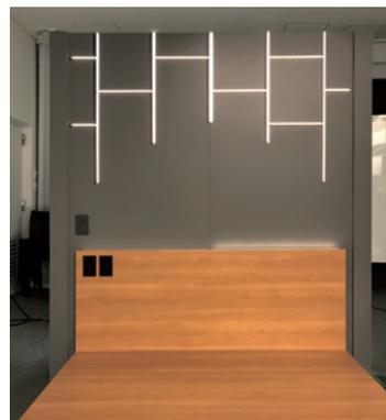
3種のLEDモジュール (MU-LED、XC-LED2、MC-LED4) の明るさと細さの比較展示。下限値 (1%) のほのかな明るさを体感できます。
