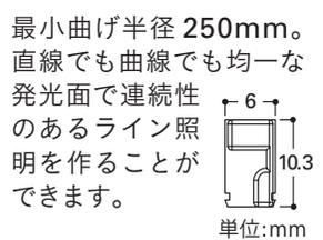
最小曲げ半径 250mm。直線でも曲線でも均一な発光面で連続性のあるライン照明を作ることができます。
